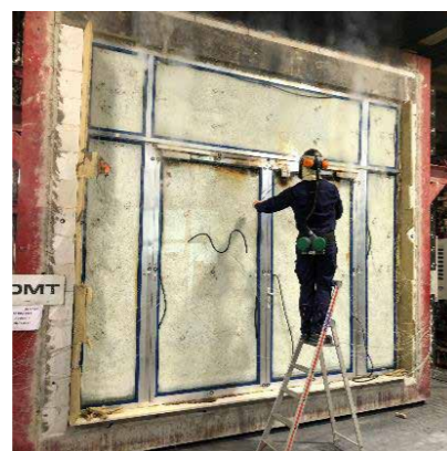
Durante o ensaio, nada se pode inflamar no lado protegido. O responsável pelo ensaio certifica-se deste facto segurando um disco de algodão nas zonas críticas.
