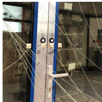
Os termopares instalados em todo o elemento de ensaio monitorizam o aumento da temperatura da superfície.
